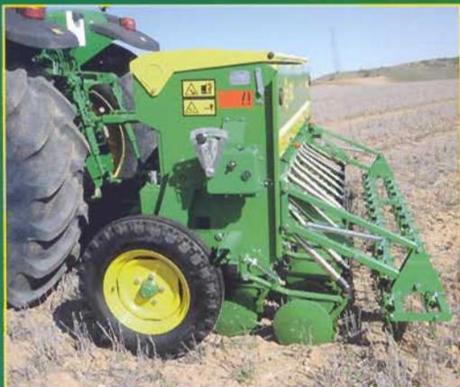
**Sembradora de gran precisión de siembra, con sistema abresurco de doble disco, para todo tipo de semillas, tubos de caída telescópicos y gran robustez.**
