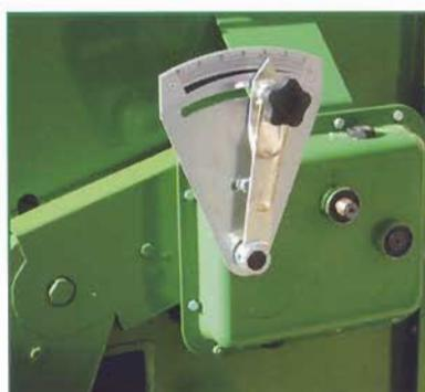
**Distribuidor de doble dentado y variador de velocidad en baño de aceite.**
